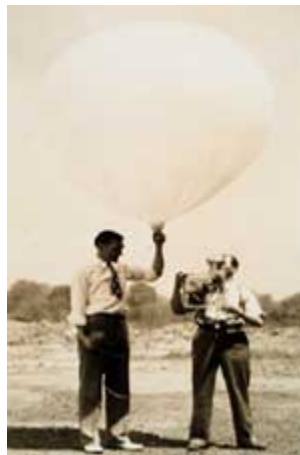
Lanzamiento de una sonda meteorológica en Washington D.C. durante el año 1936. Aun en la actualidad se utiliza un sistema de sondas para medir variables atmosféricas (Imagen de U.S. Centennial of Flight Commission).
